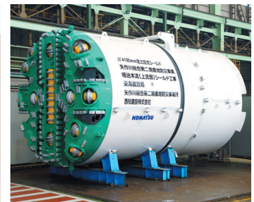
シールド機全景写真
