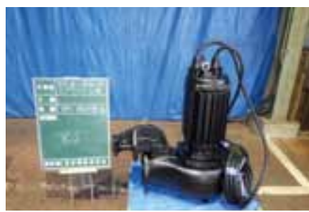
鹿乗揚水機場地区(安城市東町地内他) ポンプφ250オーバーホール
